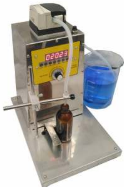
VISTA DOSATRICE IN CORRETTO POSIZIONAMENTO DI LAVORO PER PRODOTTI LIQUIDI E SEMILIQUIDI A PESCAGGIO
