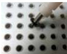
UGELLO SPECIFICO CON TUBO PER RIEMPIMENTO CAPSULE
