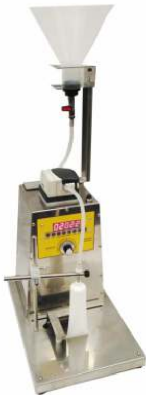
VISTA DOSATRICE IN CORRETTO POSIZIONAMENTO DI LAVORO PER PRODOTTI VISCOSI /CREME CON UTILIZZO TRAMOGGIA
